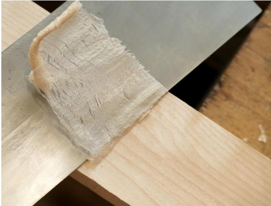
**Bild 18: Span einer aufwändiger geschärften 90°- Zieh Klinge**
