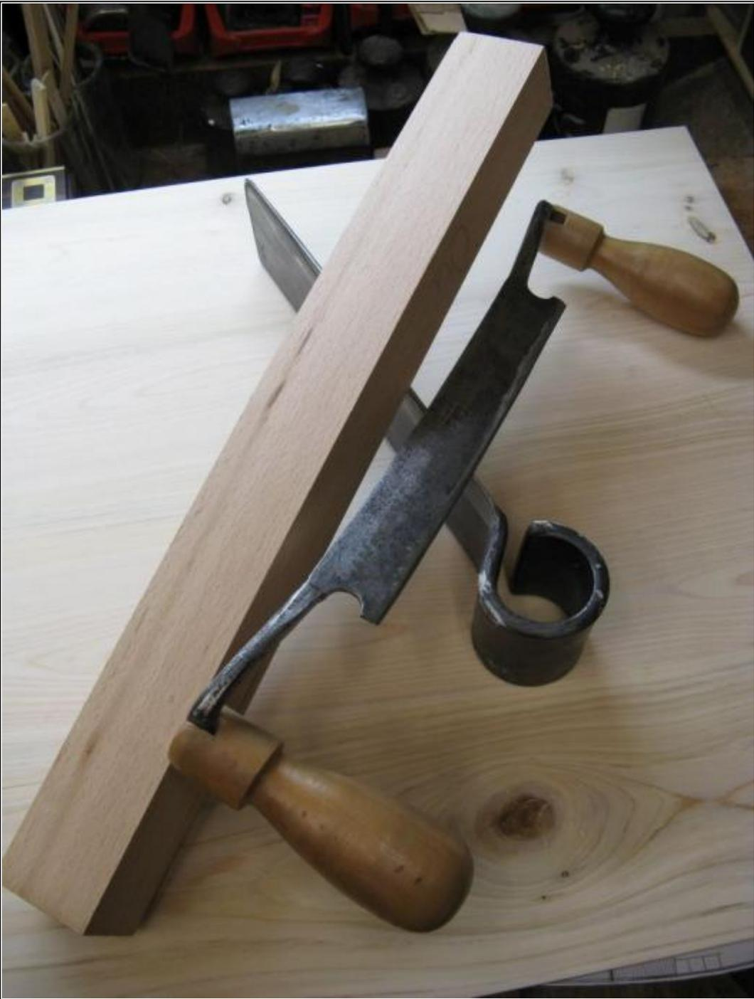
Aus einem Buchenkantel, mit langer Faser, wird mit den Ziehmessern die Form hergestellt.
