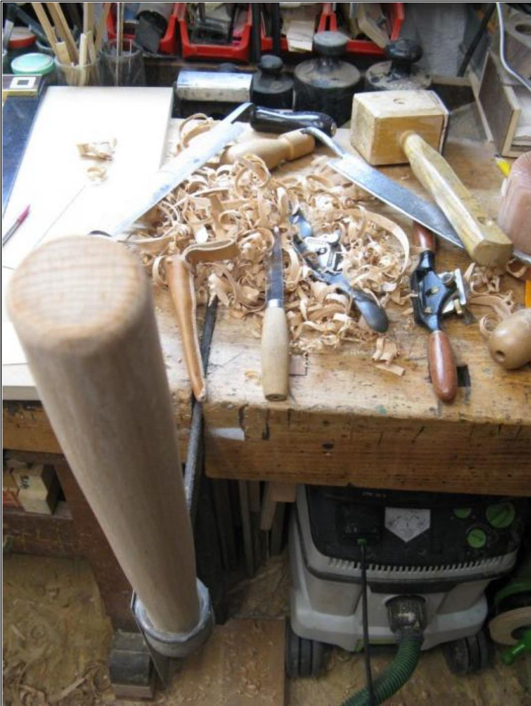
Mit den Schabhobeln nachgearbeitet und das Schnitzmesser am Stielende eingesetzt.
