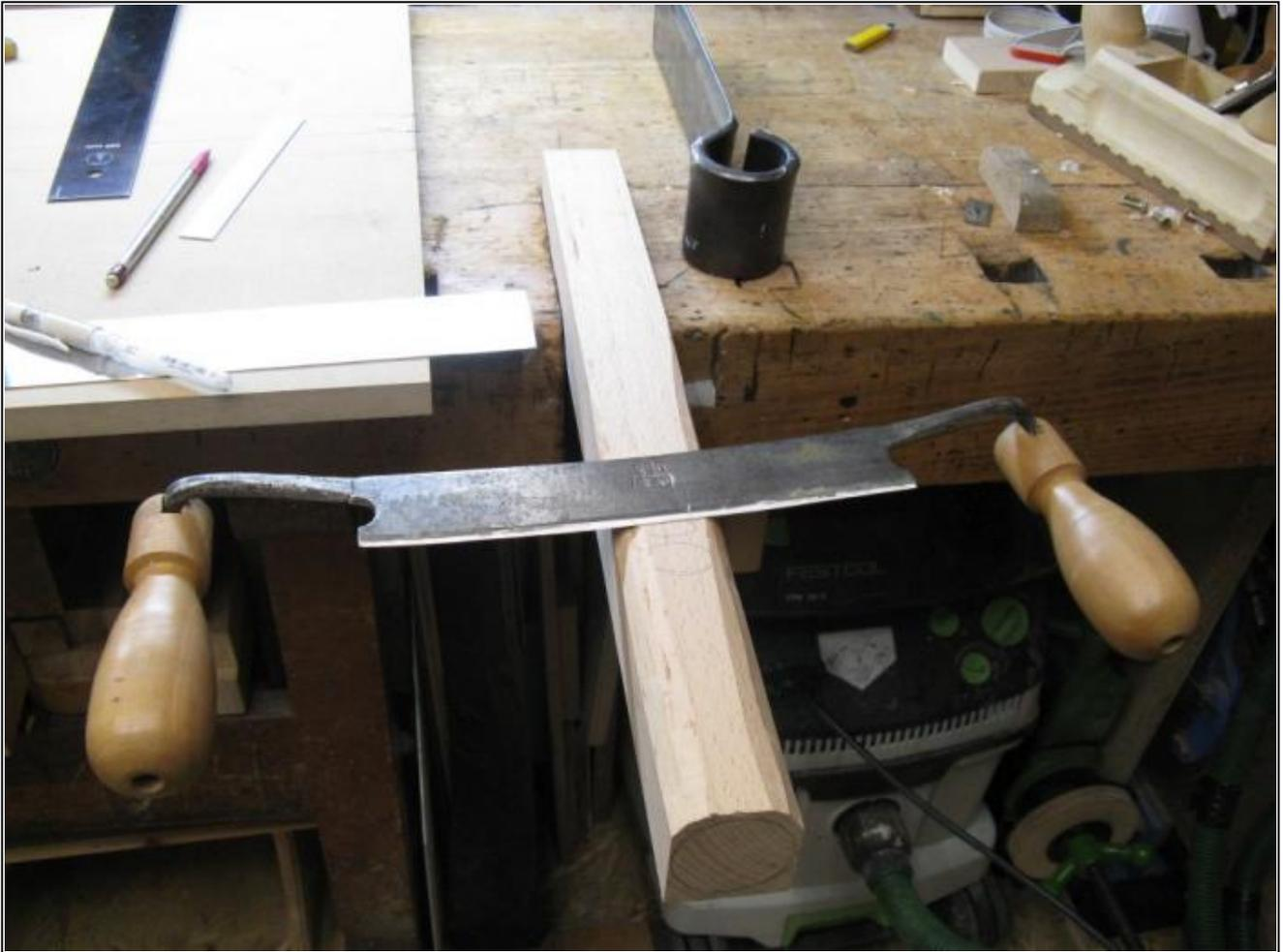
Der Durchmesser ist oben und unten übertragen und nun wird span für Span abgenommen.
