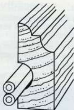
Nut zur Aufnahme von Kabeln an Fuß- leisten
