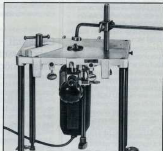
MA 8 Handoberfräse als Tischfräse mit Kopiertaste, stationär
