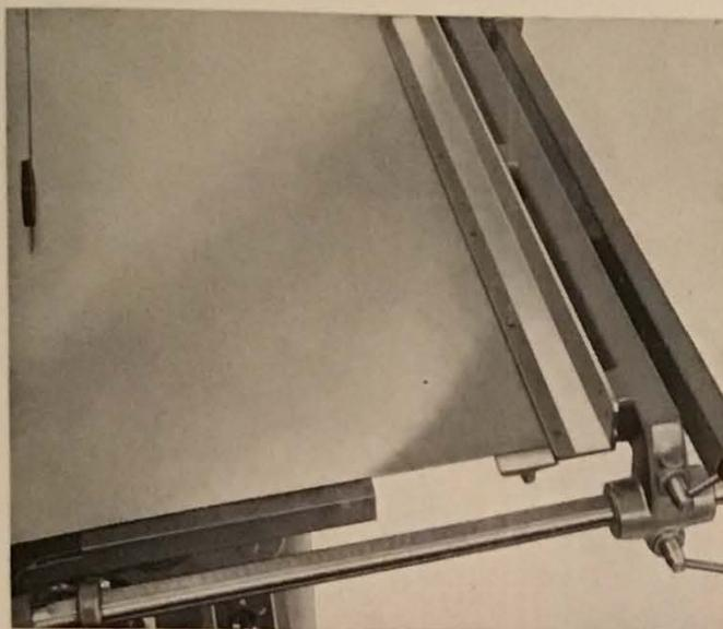
Abb. 2: Vor-Aufteilung einer großformatigen Platte am Anschlaglineal für Längsschnitte unter Verwendung von 1 verstellbaren Werkstückauflage.
