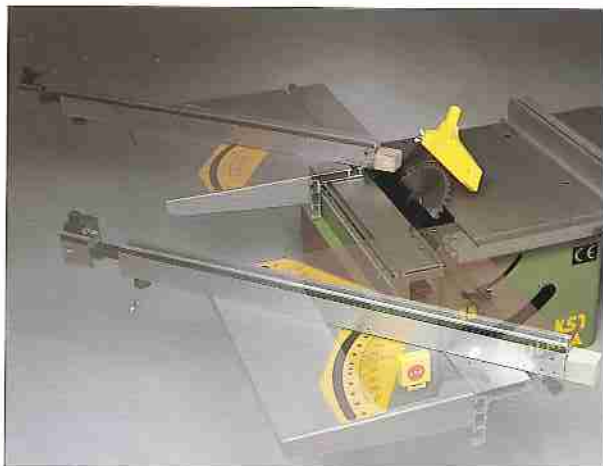
Rolltisch links vom Sägeblatt, 500 x 200 mm, mit Auflagevergrößerung, Gehrungsanschlag mit Splitterzunge, Längeneinsteller und Anschlagverlängerung bis 1500 mm Meßlänge.
