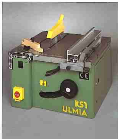
Grundmaschine Nr. 8101 und Nr. 8102 mit Parallelanschlag, Spaltkeil mit Schutzhaube und Schiebstock. Drehzahlen der Sägewelle n = 2000/4500 U/min.
