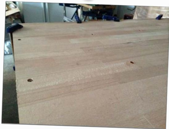
Die Löcher wurden mit Molto Holzkitt gefüllt und anschließend geschliffen.
