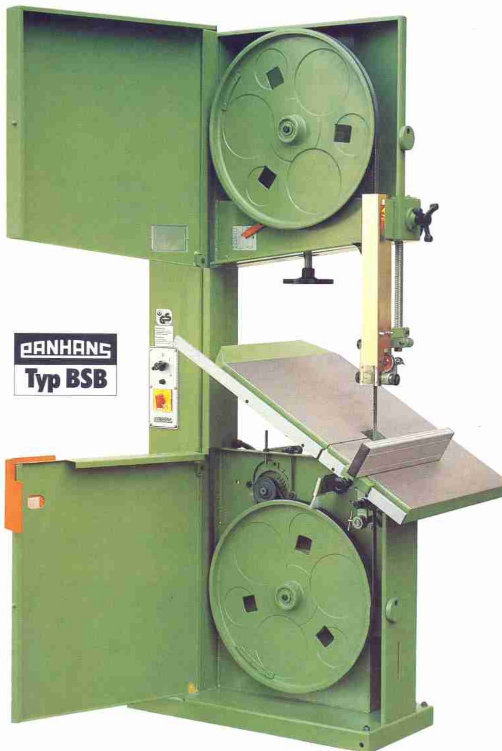
Mechanische Höhenverstellung der oberen Führung durch Handrad und Sperritzel. Kontrollfenster für den Blattlauf.
