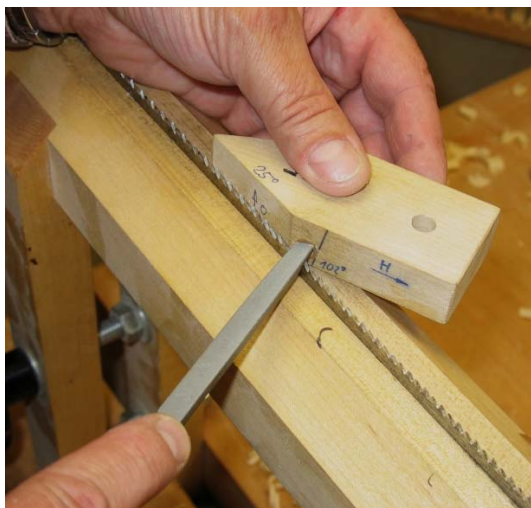
Bild 19: Ausrichten der Feile an einer Qs- Bezeichnung mit Winkellehre (Libelle abgenommen)
