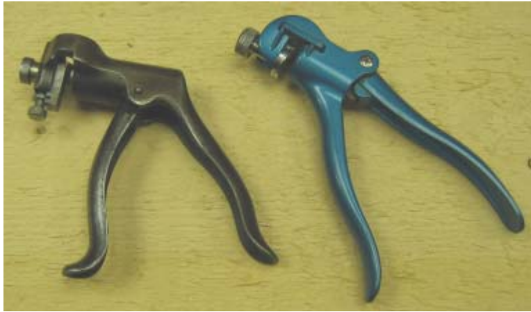
Bild 20: Schränkzangen. links: Stanley 42X, rechts: Somax
