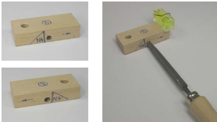
Bild 17 links: Winkellehre für Ls (Längsschnitt) – bezahnungen, rechts: Feile mit Lehre (und aufgeklebter Libelle)
